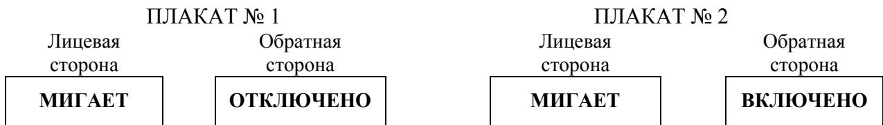
Плакаты № 1 и 2 служат для показа положений выключателей. Для показа отключеного положения автоматически отключившегося выключателя вывешивается плакат № 1 с надписью «Мигает», а для показа автоматически включившегося выключателя вывешивается плакат № 2 с той же надписью.
